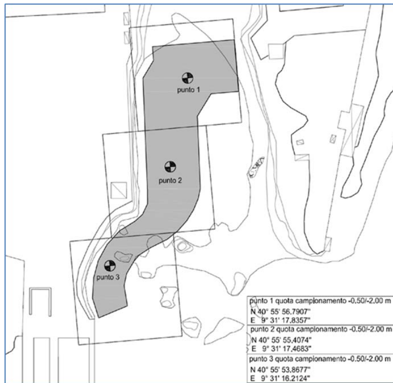
Figura 2 – Ubicazione indagini di caratterizzazione 2011
