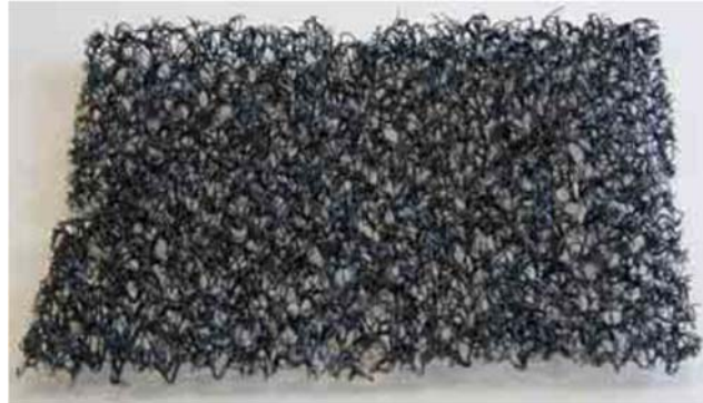
Esempio di struttura di geostuoia
