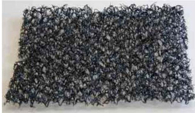
Esempio di struttura di geostuoia
