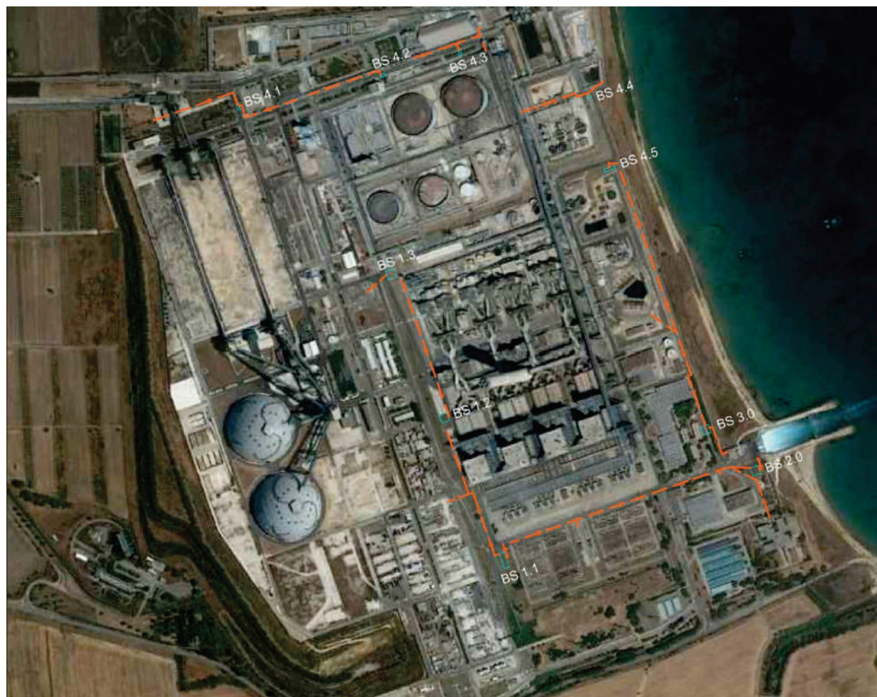
Figura 5.6.4 – Brindisi Sud – Post operam, viene indicata la localizzazione delle vasche e dei collettori interrati
