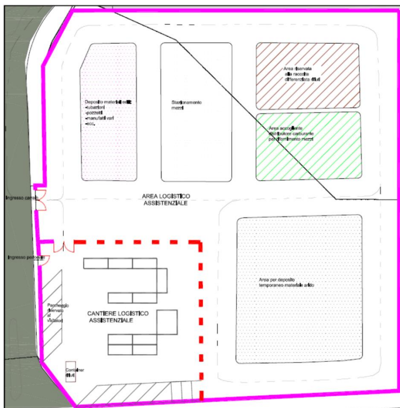
Figura 87 – Schema tipo del cantiere base
