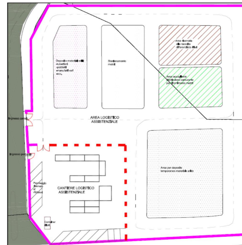
Figura 2 – Schema tipo del cantiere logistico.
