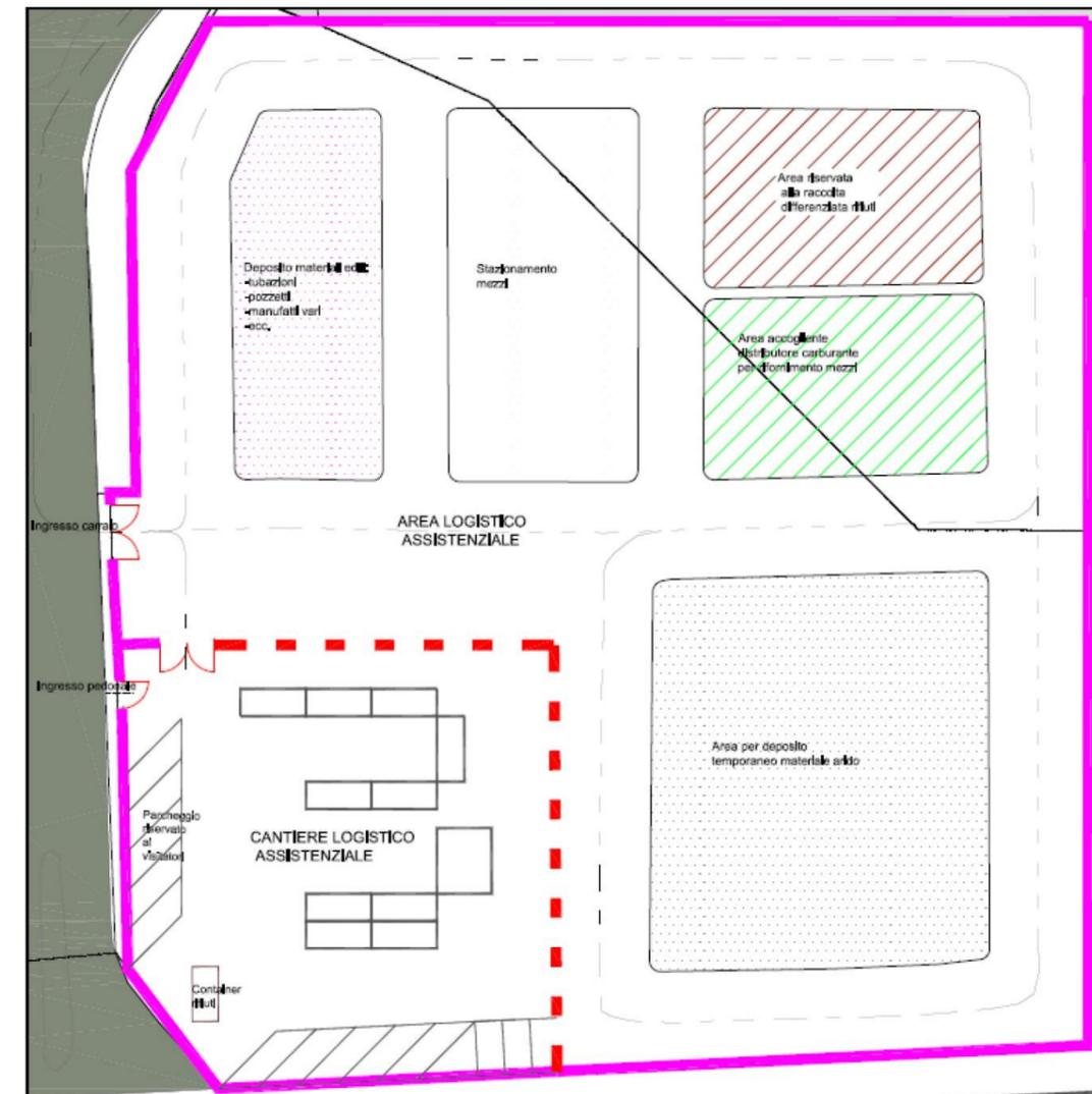
Figura 4 – Schema tipo del cantiere logistico.
