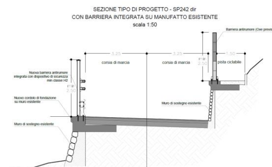
Figura 15 – Sezione tipo Barriera integrata su manufatto esistente
