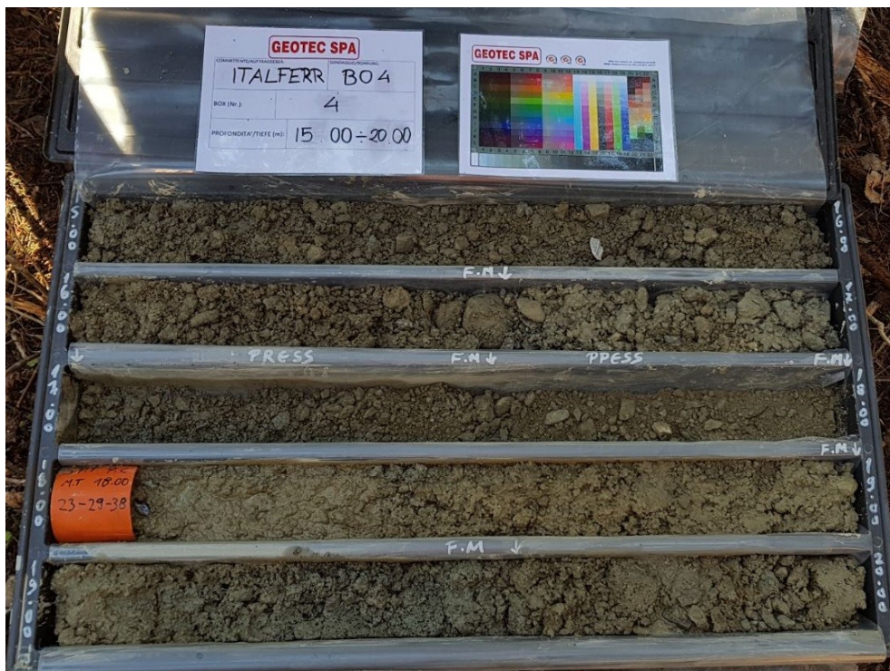
Varna-Italferr: BO4 - Box 4 – m 15.00 ÷ m 20.00
