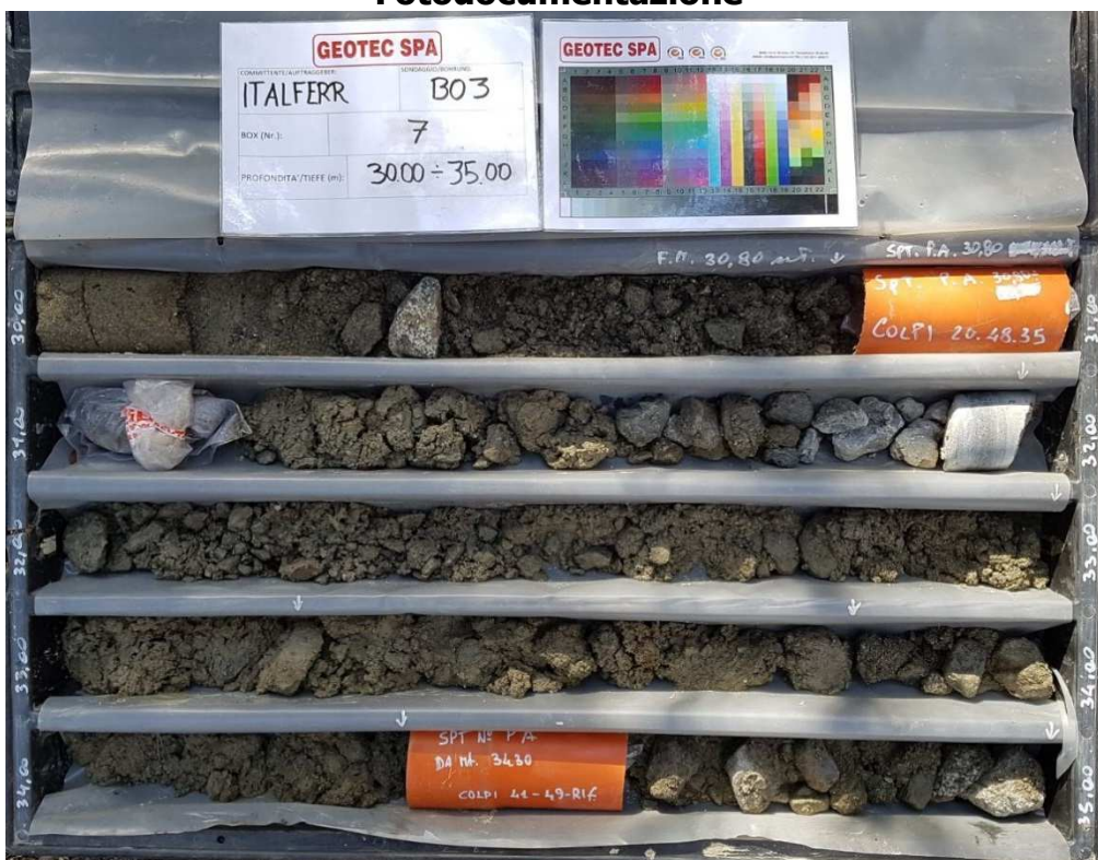
Varna-Italferr: BO3 - Box 7 – m 30.00 ÷ m 35.00
