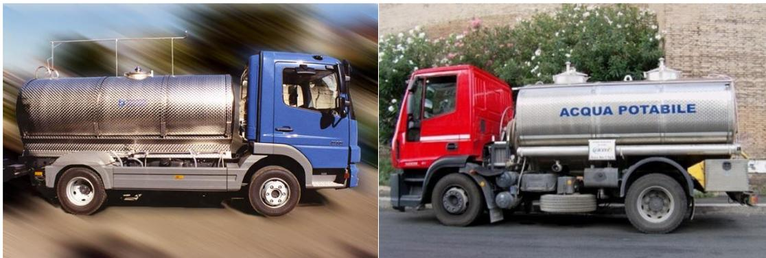
Figura 12 – Esempio di autobotte per trasporto acqua potabile.
