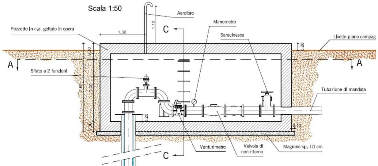
**Figura 10 – Pianta e sezione dei pozzetti di alloggiamento pompe .**
