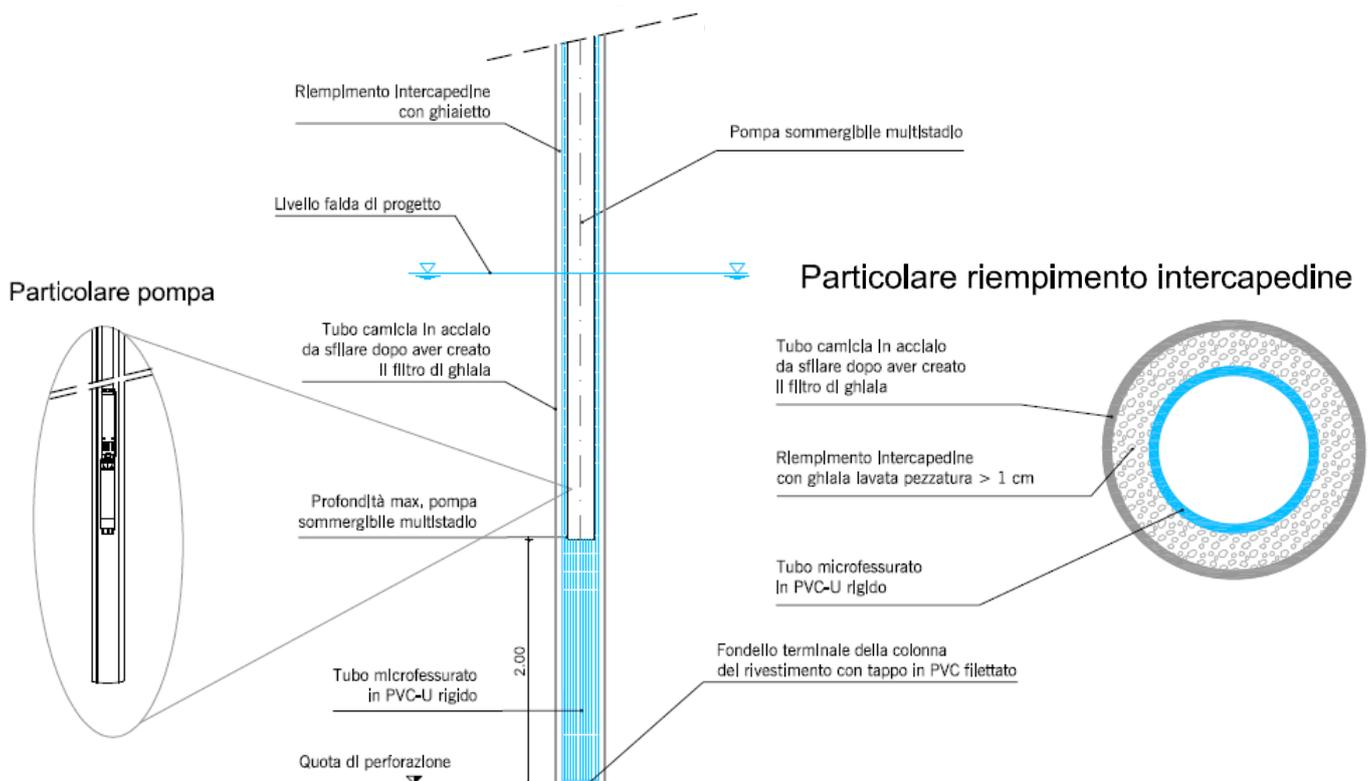
**Figura 8 – Sezione tipo del pozzo e particolare riempimento intercapedine.**
