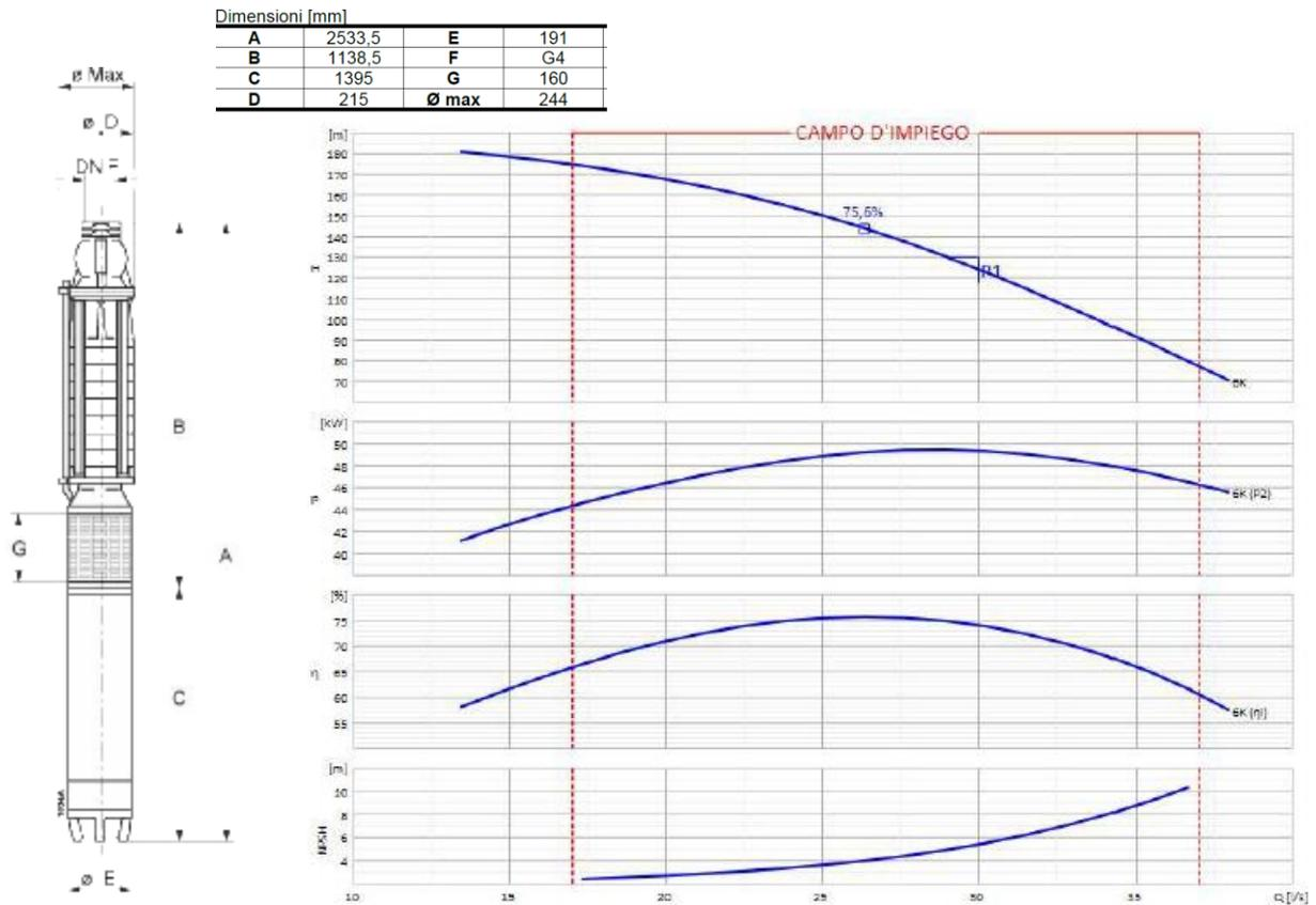
Figura 11 – Caratteristiche dimensionali e di esercizio della pompa da pozzo prevista.
