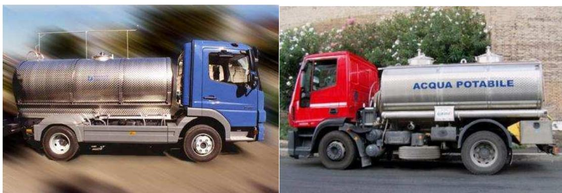
**Figura 19 – Esempio di autobotte per trasporto acqua potabile.**
