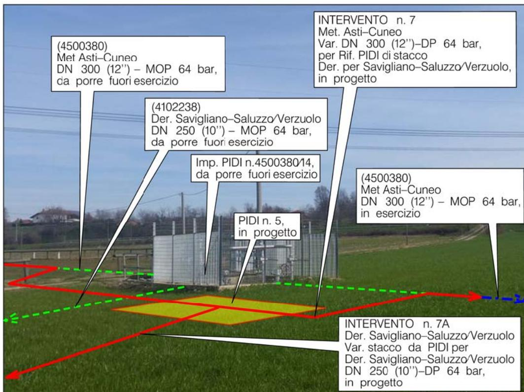
**Intervento n. 8, Met. Asti Cuneo DN 300 (12"), Variante DN 300 (12") DP 64 bar per rifacimento PIDI di stacco
