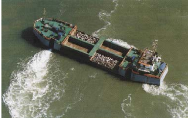
Figura 3.15: “Side stone dumping vessel”, tipo di imbarcazione utilizzata per il versamento in mare di materiale ghiaioso e pietrisco.
