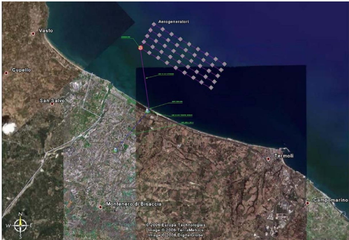
Figura 4.66: Layout di progetto con indicazione delle diverse componenti. La linea bianca che collega la sottostazione alla stazione di smistamento GRIN è una linea a 150 kV.
