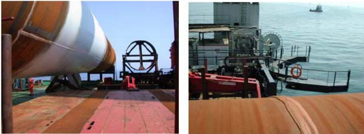
Figura 3.17: Tilting frame , dispositivo per inclinare i pali e portarli in posizione eretta; hammering frame , dispositivo per tenere i pali perfettamente verticali.
