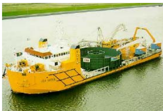
Figura 3.25: Nave per l'installazione di cavi di grosso diametro offshore.
