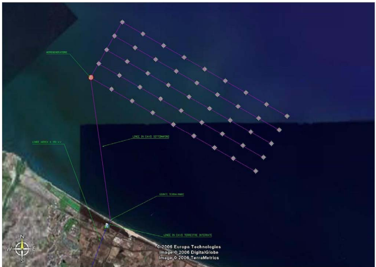
Figura 3.7: Cavi di collegamento tra gli aerogeneratori.
