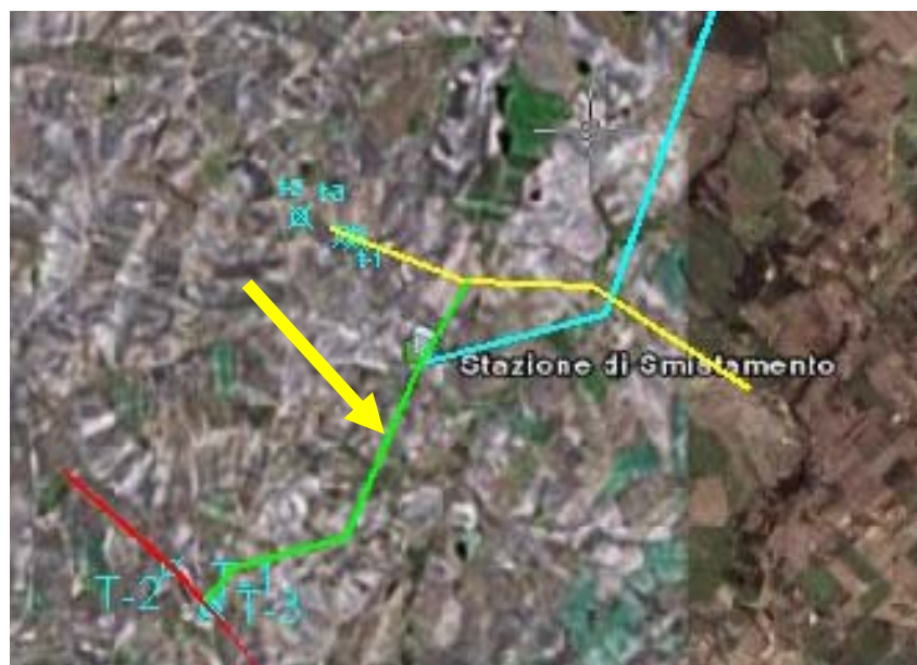
Figura 3.11: Tratto di collegamento tra la linea Gissi Larino della rete di trasmissione nazionale e la stazione di smistamento aerea. La linea verde indica il percorso dei nuovi cavi, mentre le linee rossa e gialla indicano le linee esistenti.
