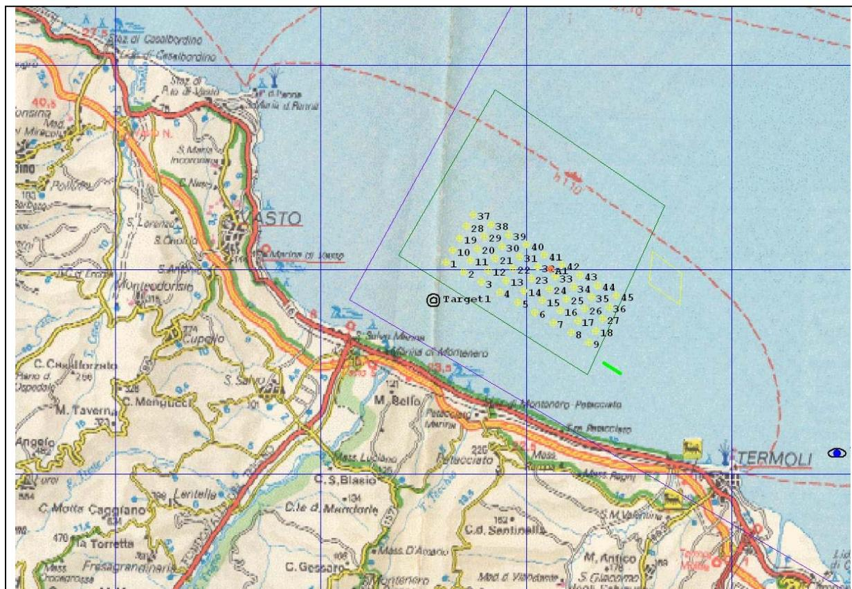
Figura 4. 27: Mare tra Termoli e le Tremiti: punto di vista (pallino blu) e layout della centrale eolica. In giallo le turbine, mentre le aree delimitate dalle linee colorate individuano i limiti descritti al Paragrafo 2.1.
