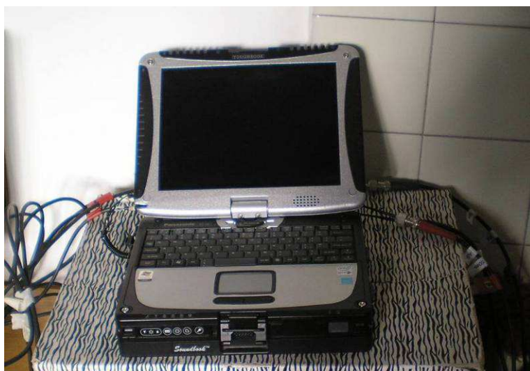
Figura 1 - Analizzatore Sinus mod. Soundbook S/N 6255
