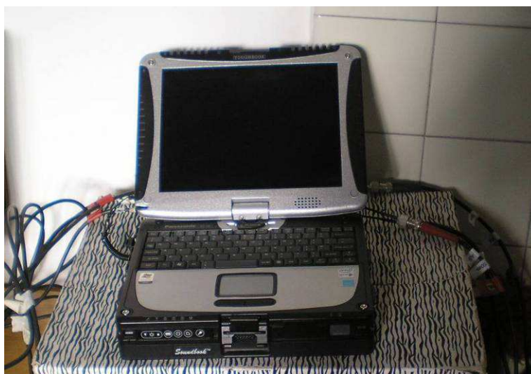
Figura 1 - Analizzatore Sinus mod. Soundbook S/N 6255
