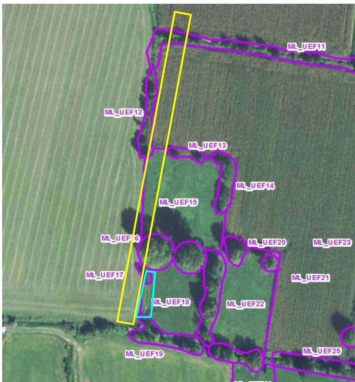
Figura 3.6 – Localizzazione del conflitto diretto tra pista di cantiere ed unità eco-floristiche (in giallo l'ingombro della pista; il azzurro aree scoticate ai margini)
