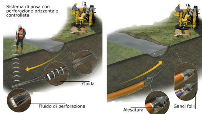
Fig. 1.5 – Posa in opera tubazione per alloggiamento cavi
