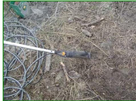
Fig. 4 geofono tridimensionale da 4,5 Hz
