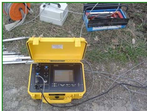
Fig. 2: Sismografo MAE A4000 S
