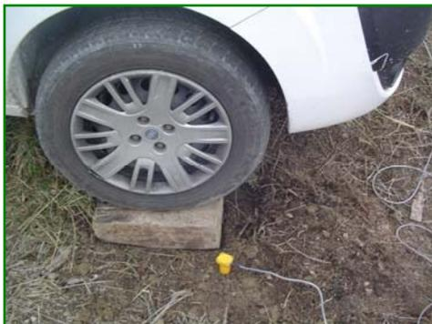
Fig. 5 Sorgente di acquisizione costituita da traversina in legno, massa battente e geofono starter
