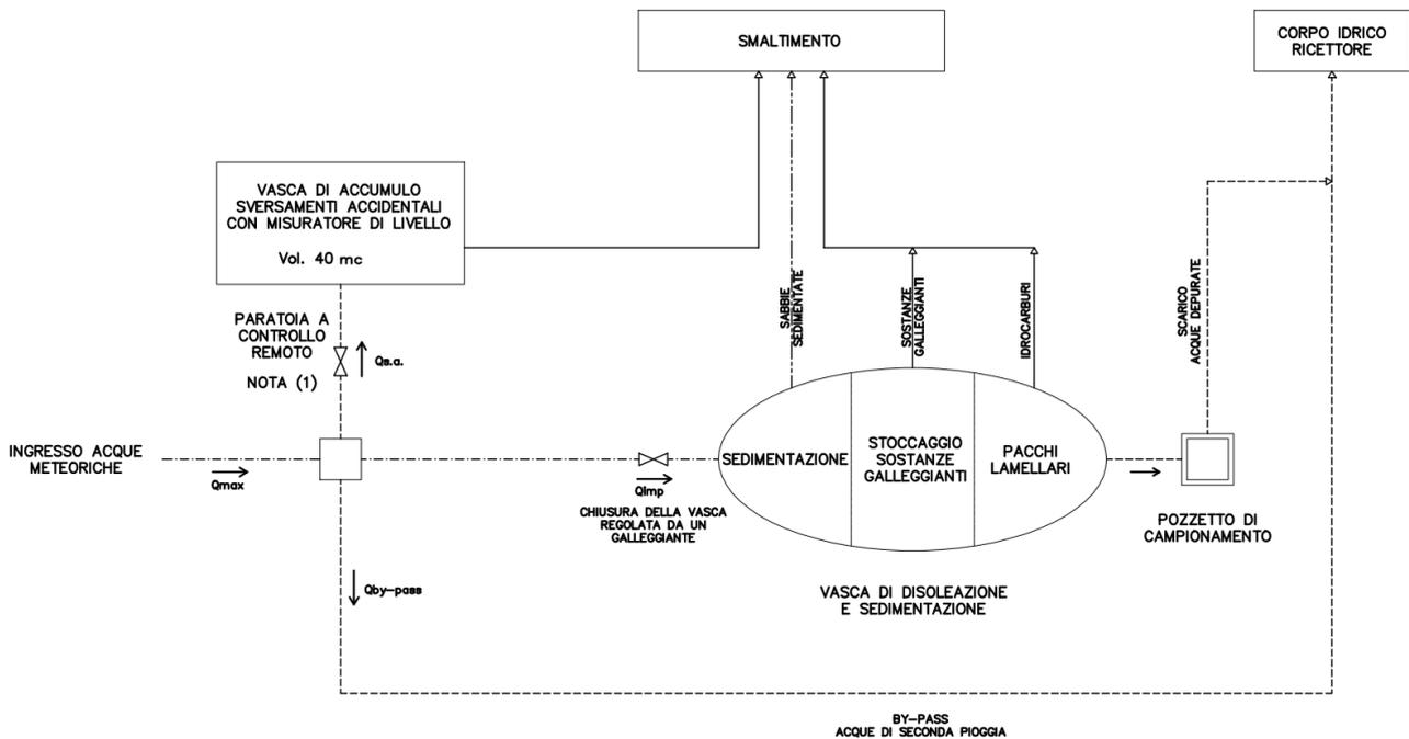
Figura 13: Diagramma di flusso dell'impianto di trattamento
