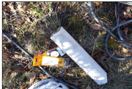
Particolare della carota estratta
