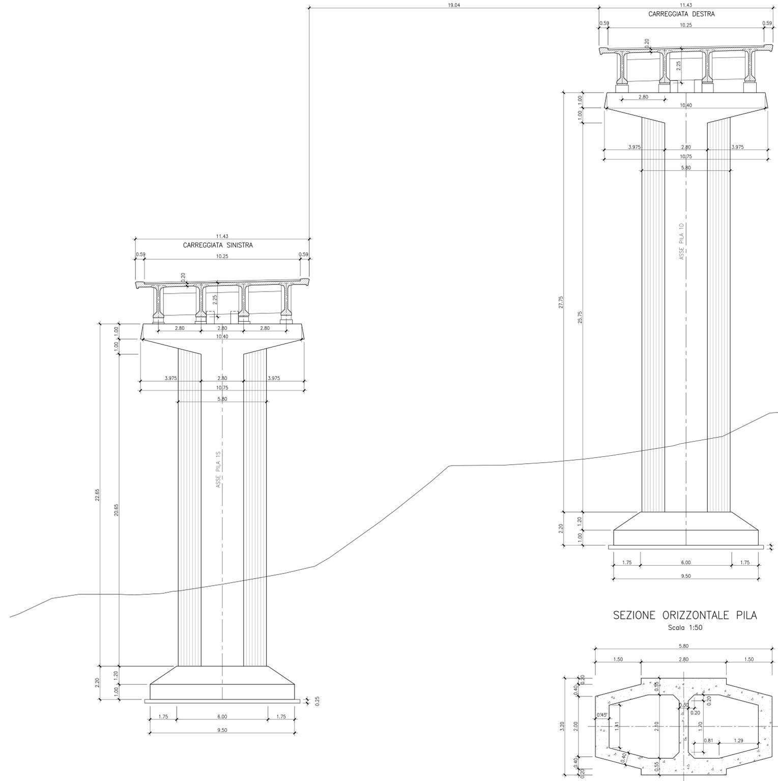
SEZIONE ORIZZONTALE PILA
