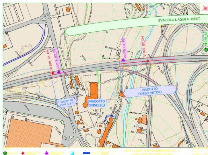
Figura 8: Ubicazione planimetrica delle prove in sito - Fosso Vetoio
