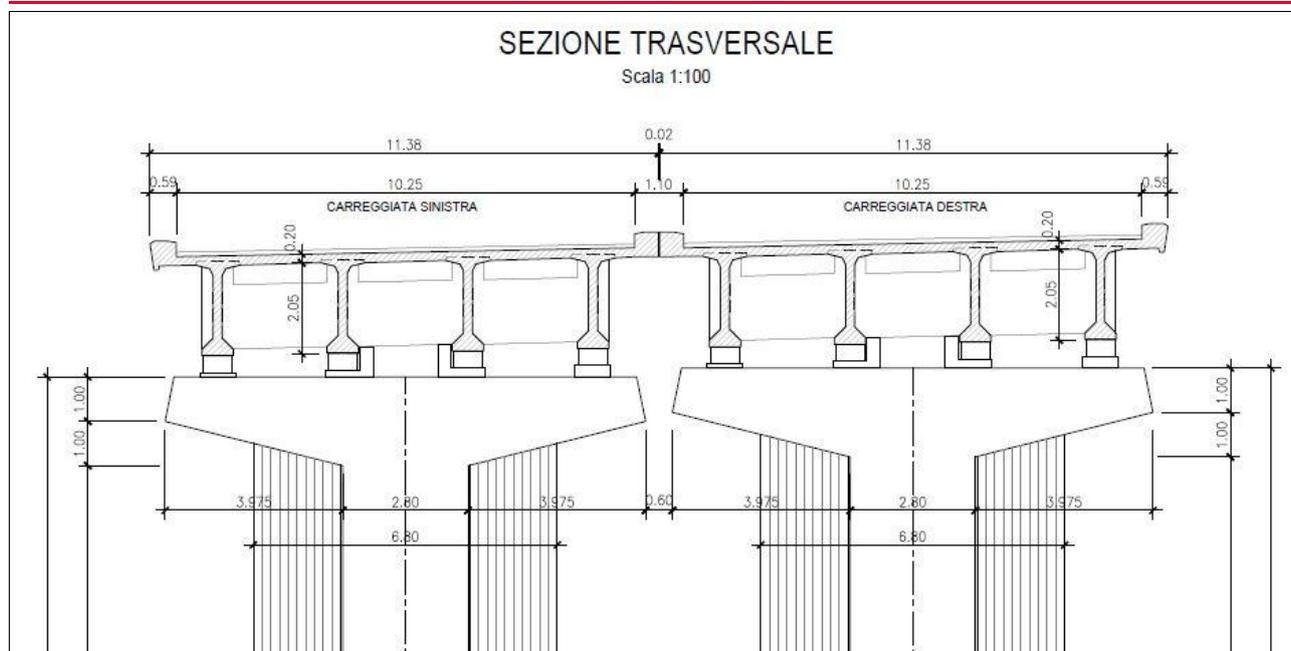
Figura 2: sezione tipologica dello stato attuale (opere a travi)
