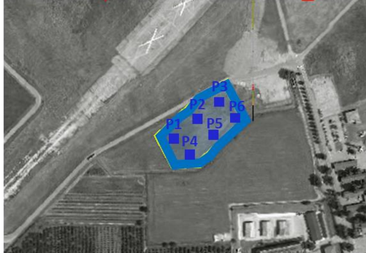
Figura 5-22 Ubicazione dei punti di campionamento – Sito di deposito intermedio Di_1
