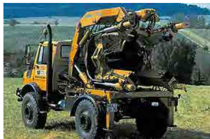
Esempi di attrezzature e macchinari che saranno utilizzati per il trapianto delle alberature esistenti
