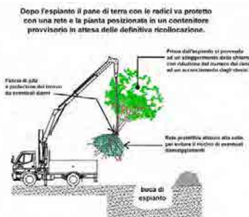
Esempi di procedure ed attenzioni che saranno osservate durante le fasi di trapianto
