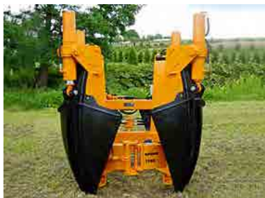
Esempi di attrezzature e macchinari che saranno utilizzati per il trapianto delle alberature esistenti
