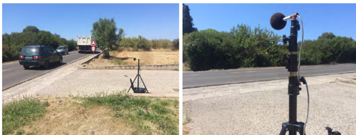
Figura 6 Installazione postazione fonometrica PS2-A sulla SS 293 tratto Piscinas-Giba
