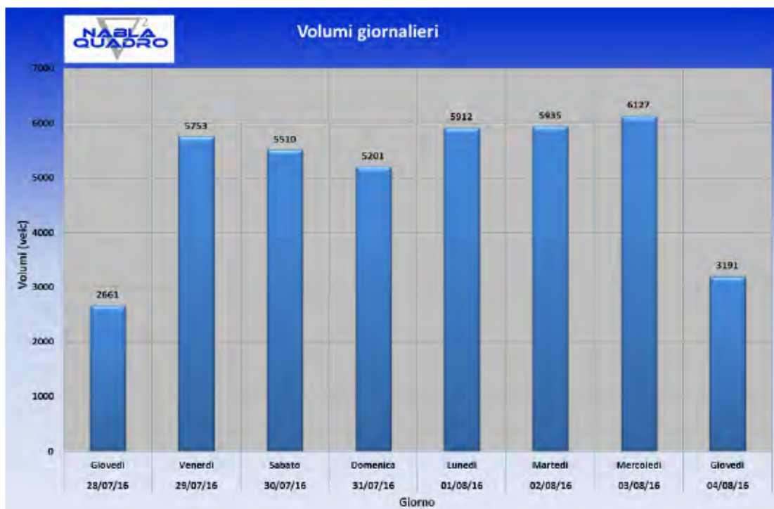
Figura 14 Volumi giornalieri di traffico veicolare nel sito TR-A sulla SS 293 tratto Piscinas – Giba
