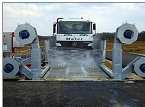
Esempio di impianto di lavaggio gomme e impianto di lavaggio canale autobetoniere
