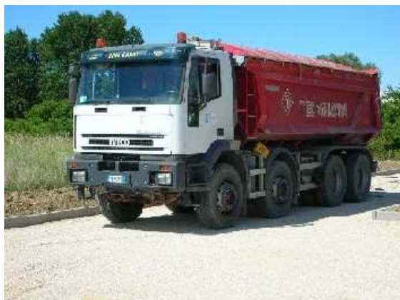
Camion per trasporto materiali pulverulenti dotati di teli per il contenimento dell'emissione di polveri
