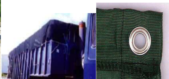
Camion per trasporto materiali pulverulenti dotati di teli per il contenimento dell'emissione di polveri
