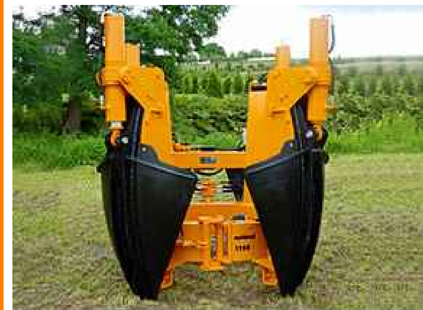
PARTICOLARE DELLE VANGHE DI SCAVO
