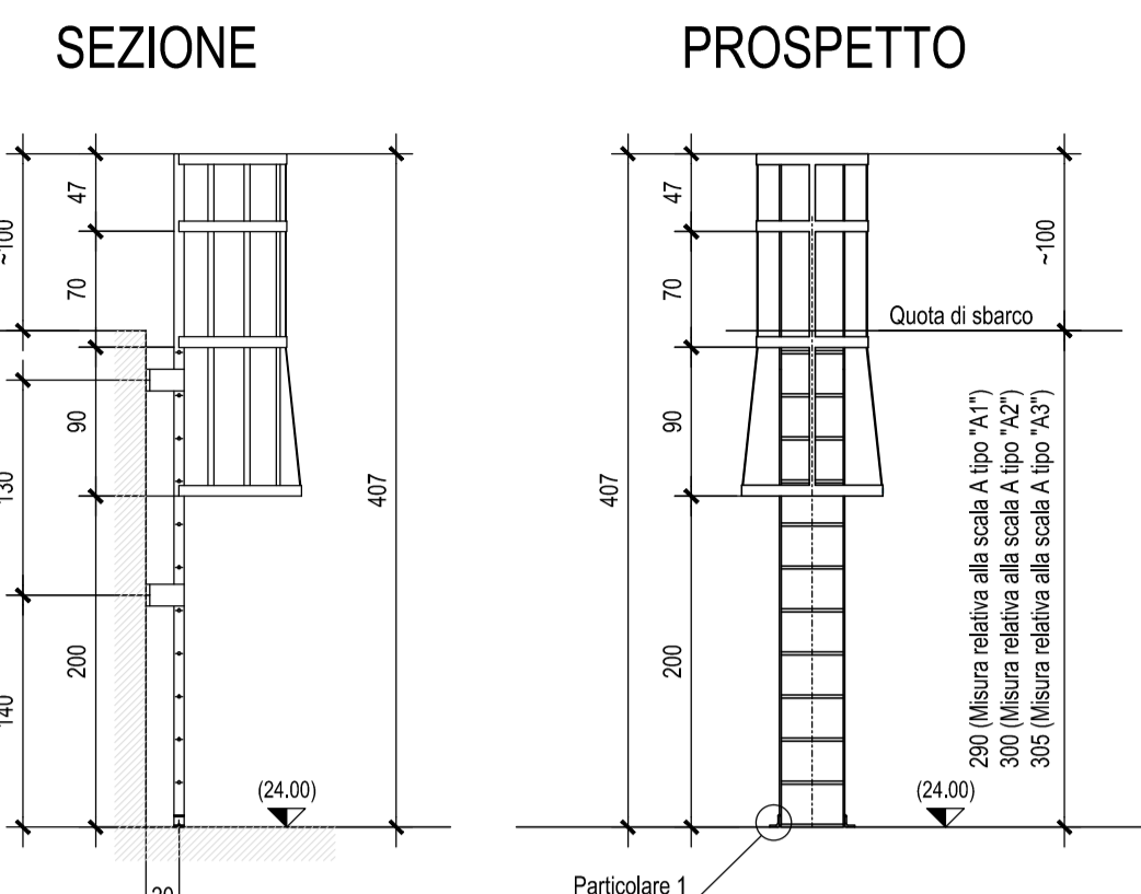
SCALA "A" CON SBARCO - Scala 1:50
