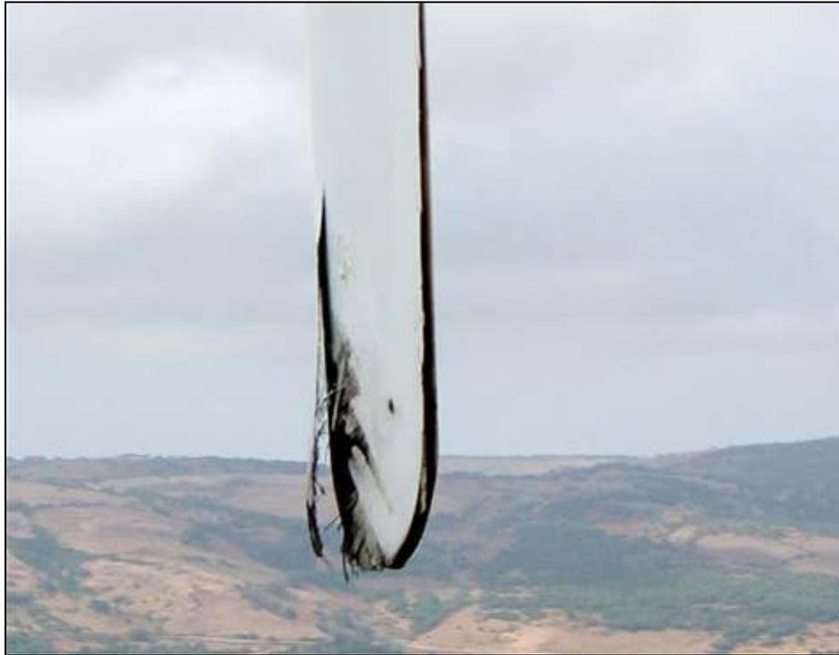
**Figura 3: Estremità di pala danneggiata da fulminazione atmosferica.**
