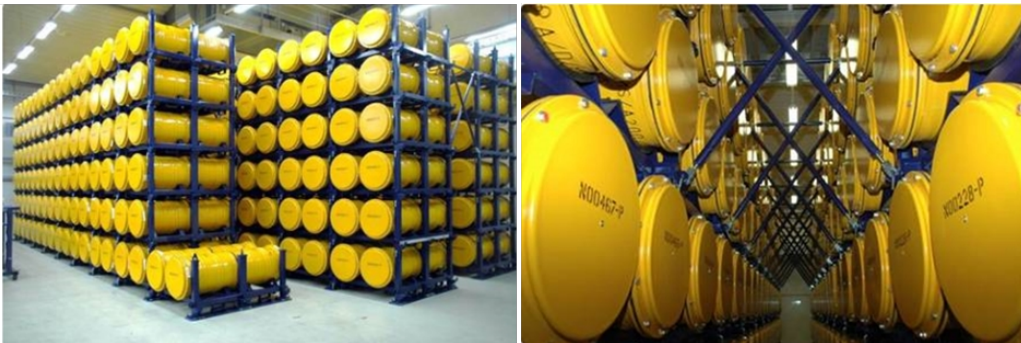
Abbildung 5: Zwischenlagerung der konditionierten 200 Liter-Fässer
