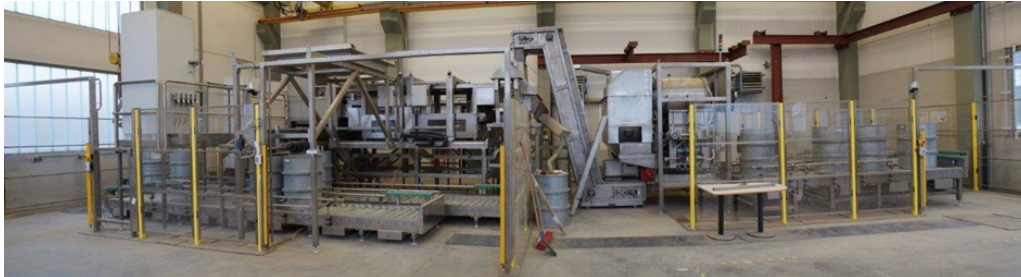
Abbildung 7: Erdmessenanlage (rechts Materialaufbringung, links Messung und Separation)
