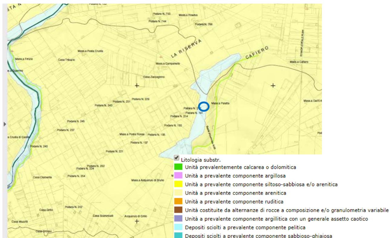
Fig. 2.2.3.F - Stralcio della Carta Idrogeomorfologica regionale relativo all'area della stazione di consegna, con interferenza del cavidotto con un ciglio morfologico
