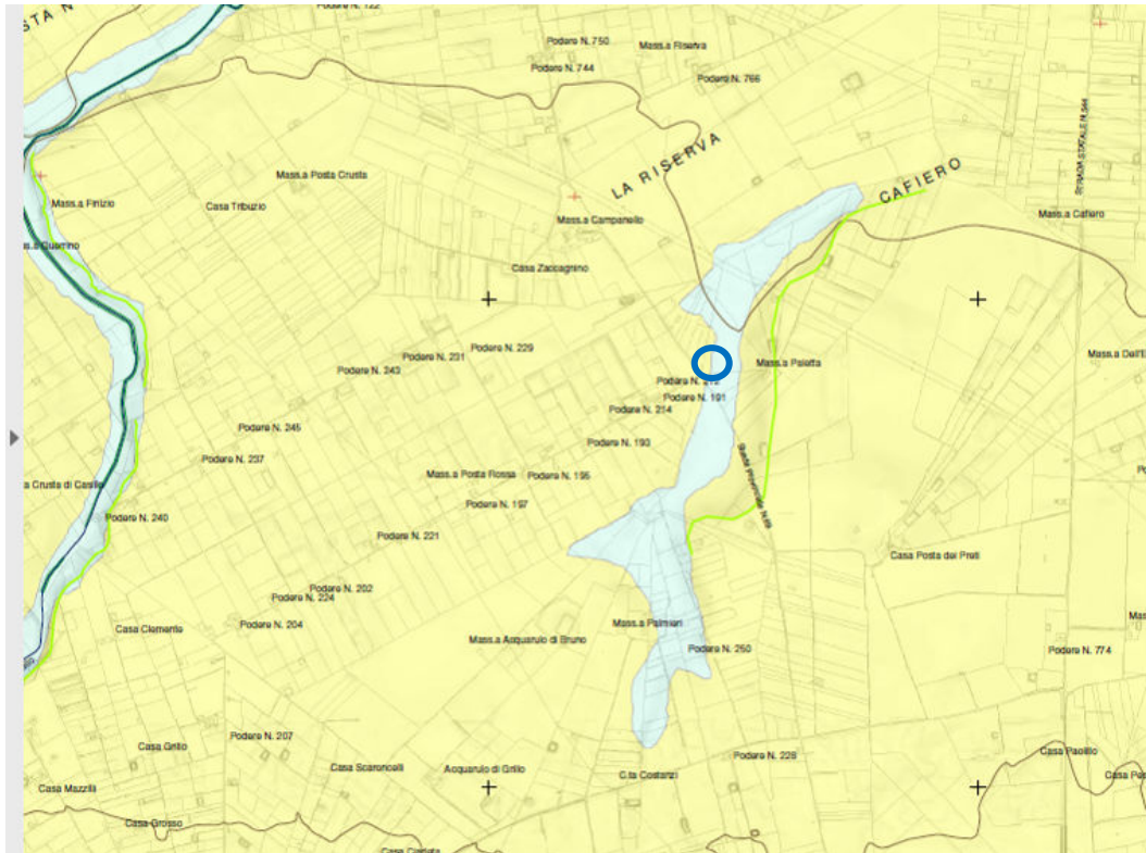
Fig.12 - Stralcio della Carta Idrogeomorfologica regionale relativo all'area della stazione di consegna, con interferenza del cavidotto con un ciglio morfologico
