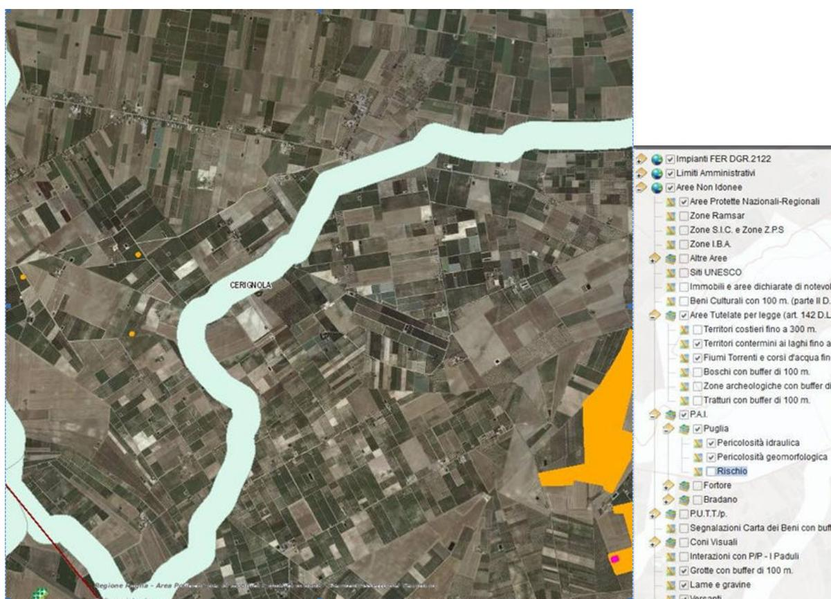
**Fig. 5.5.2.A - Mappatura regionale delle aree non idonee per insediamento di impianti eolici dal punto di vista geomorfologico e idraulico**
