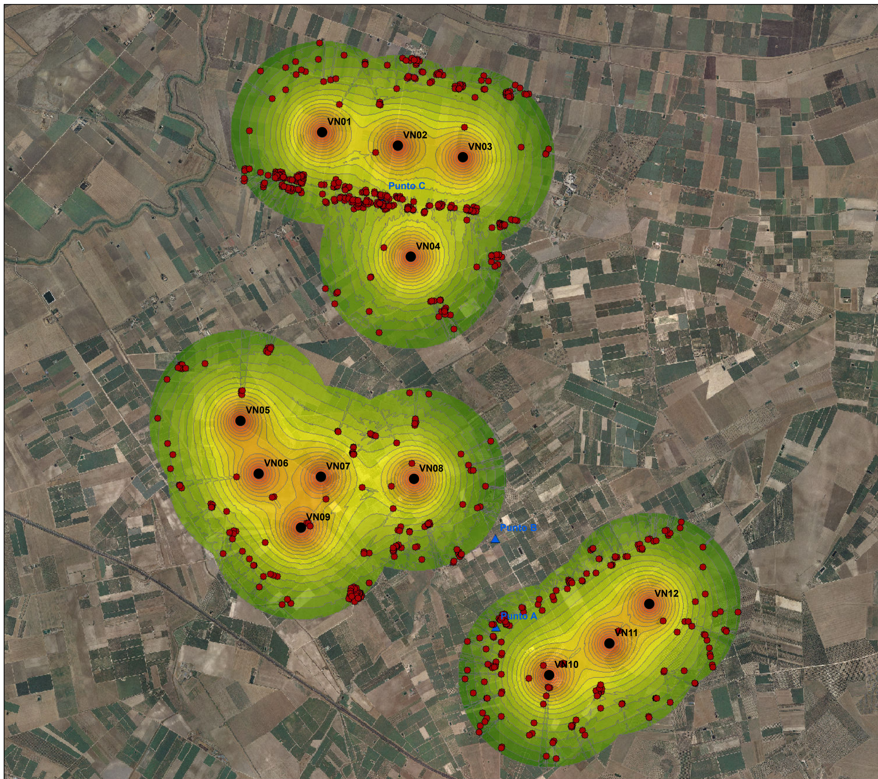
Tavola 1 – Individuazione dei possibili ricettori e dei punti di rilevamento fonometrico e mappa delle curve isosonore Scala 1:25.000
