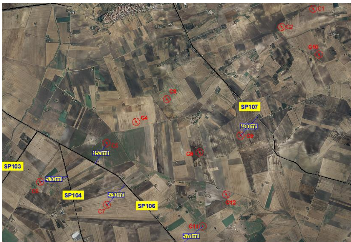
Figura 3: Distanze minime degli aerogeneratori dalle strade provinciali
