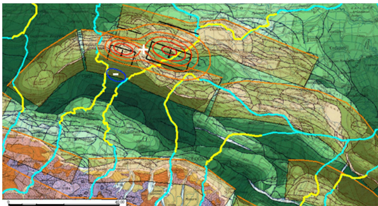
Fig. 31 - Spostamento della superficie causato dalle due faglie (riquadri neri) che generano le scosse di magnitudo 5.9 e 5.8
