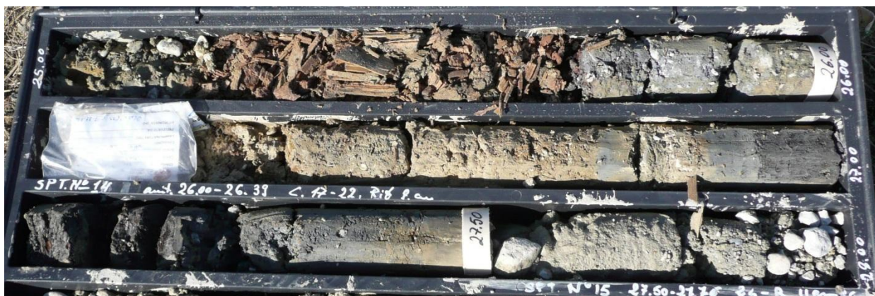
Foto 1 - Particolare del materiale ligneo catalogato nella cassetta n° 6 del sondaggio S-B3.
