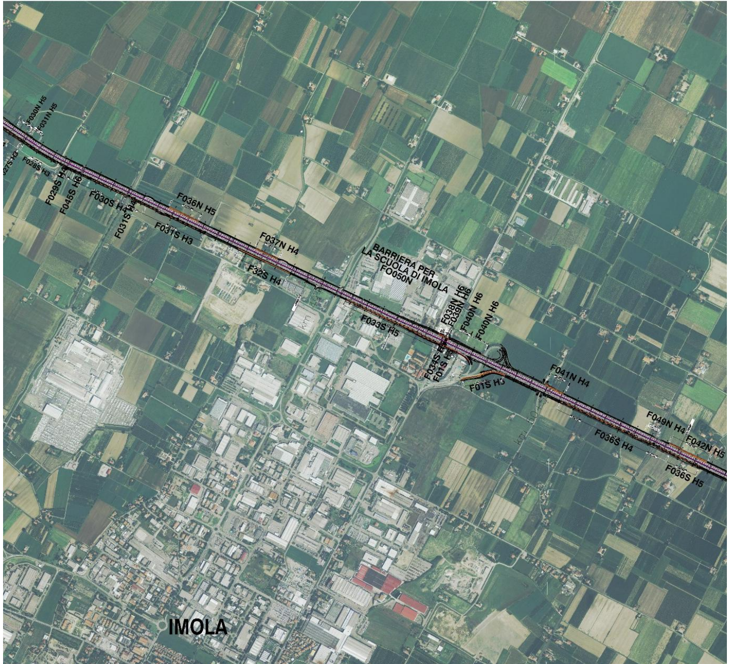
Figura 1.1.1 – Schema di un tratto planimetrico al Km 49+00, con l'ubicazione delle barriere acustiche.
