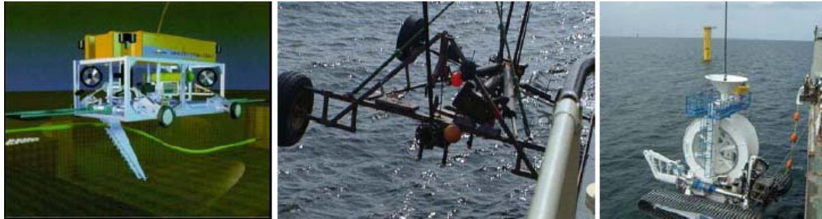
Mezzi utilizzati per l'interramento dei cavi.
