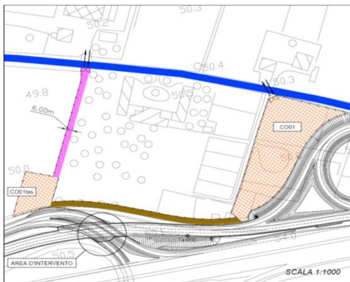
Figura 2-13 Disposizione dell'area di cantiere operativo CO01 in prossimità del ramo di svincolo di San Lazzaro; l'area risulta collegata al cantiere operativo CO01bis attraverso una viabilità interna parallela al tratto autostradale
