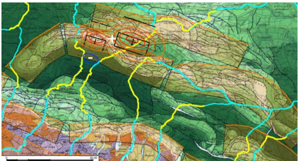
Fig. 27 - Spostamento della superficie causato dalle due faglie (riquadri neri) che generano le scosse di magnitudo 5.9 e 5.8
