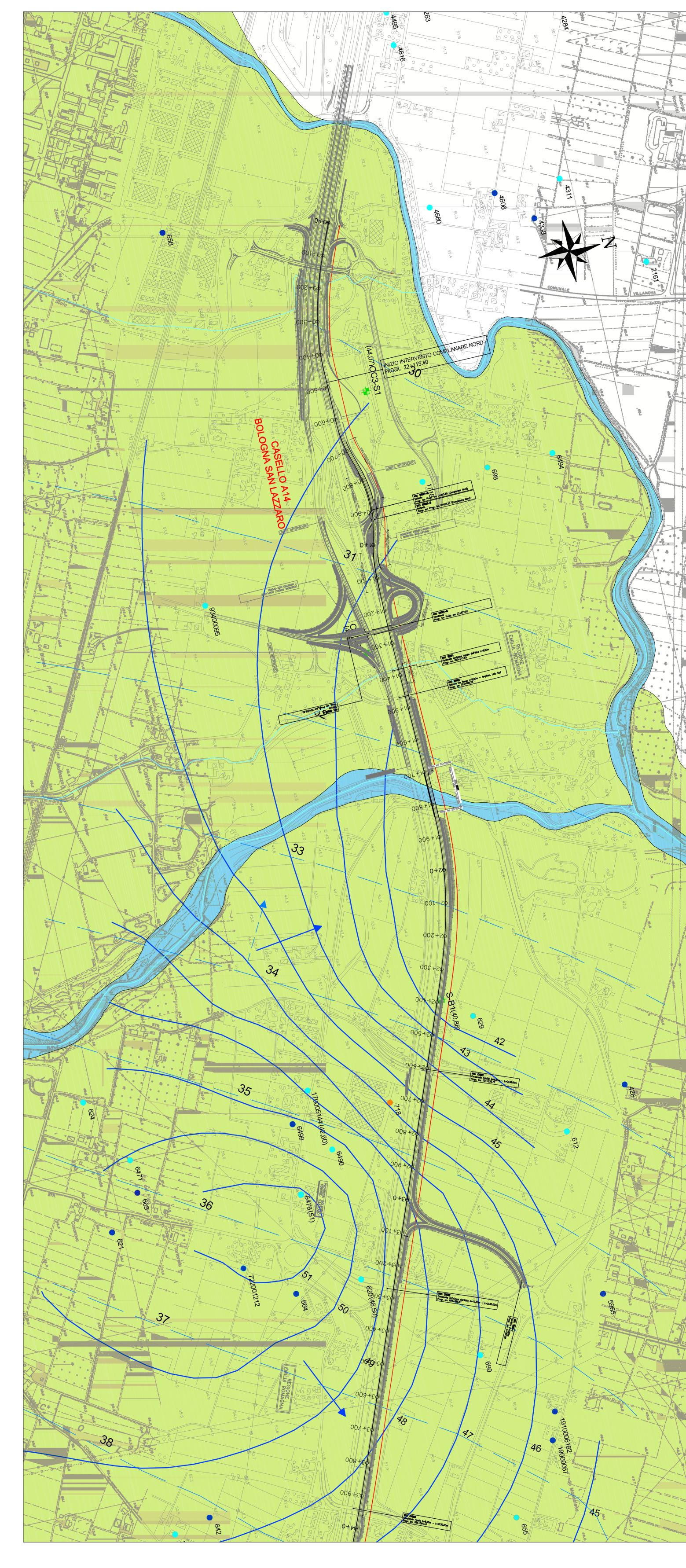
Traccia della superficie piezometrica estrapolata dal modello geostatistico svilluppatio per il progetto della Bo-Dir. Ravenna e basato sulle misure del livello di falda effettuate nei pozzi e nei sondaggi durante il periodo novembre 2010 - gennaio 2011
