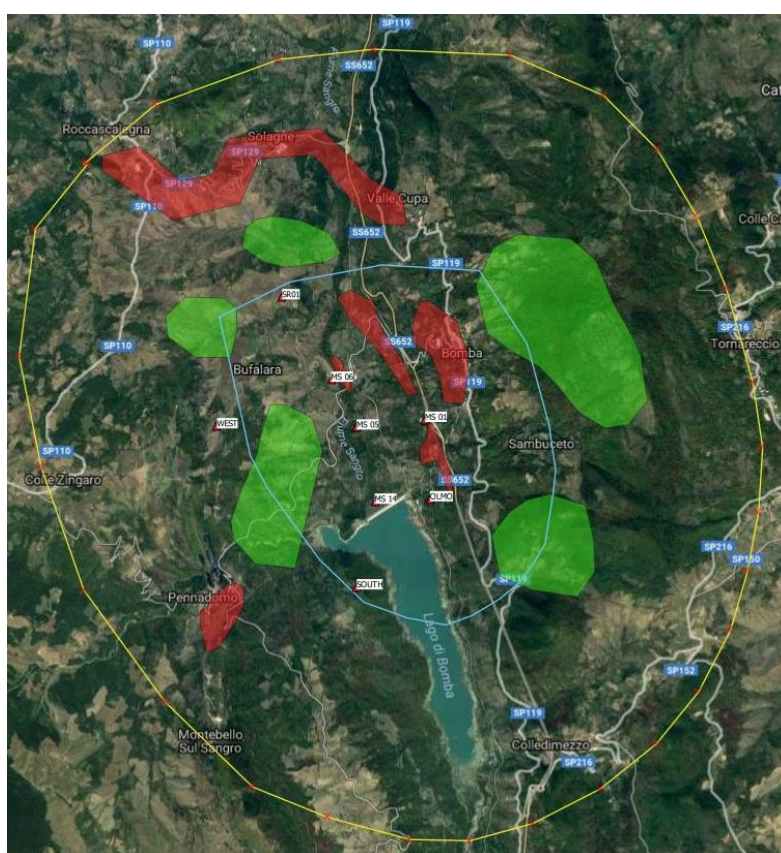
Fig. 5.9 - Mappa con l'indicazione delle zone favorevoli (verdi) e non favorevoli (rosse) per l'installazione di stazioni di monitoraggio aggiuntive. Il cerchio blu corrisponde approssimativamente all'estensione del giacimento mentre il cerchio giallo individua l'estensione del dominio interno (DI). (fig. 3.4 All. F)
