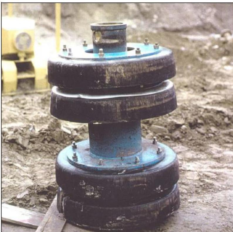
**Fig. 7.4/A: Pig convenzionale impiegato nelle operazioni di collaudo idraulico e di pulizia della condotta**
