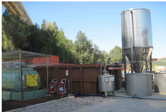
Area campo operativo: vasche impianto trattamento (a sinistra); filtropressa (a destra)
