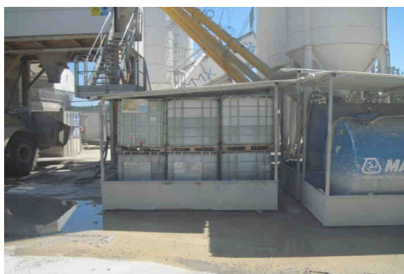
Area di betonaggio: Stoccaggio solventi (a sinistra); raccolta acque (a destra)
