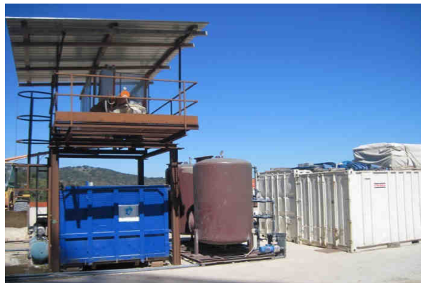
Area campo operativo: vasche impianto trattamento (a sinistra); filtropressa (a destra)
