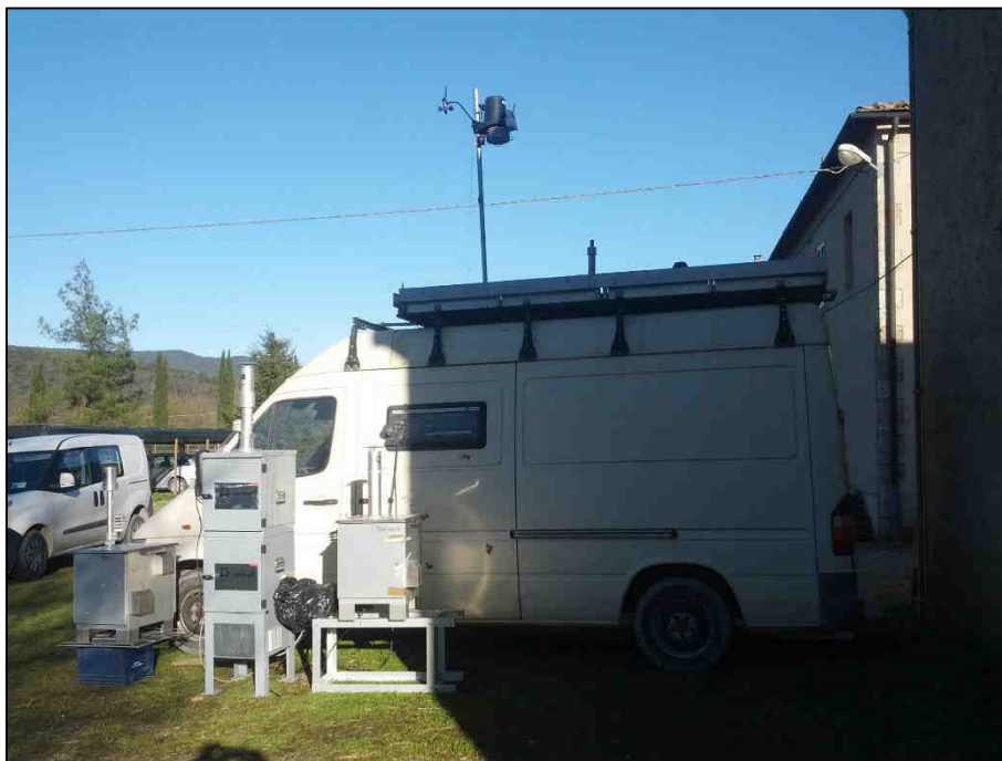
Figura 12 – Punto di monitoraggio dell'atmosfera, ATC02 / area Potatine (foto rappresentativa del punto di misura)
