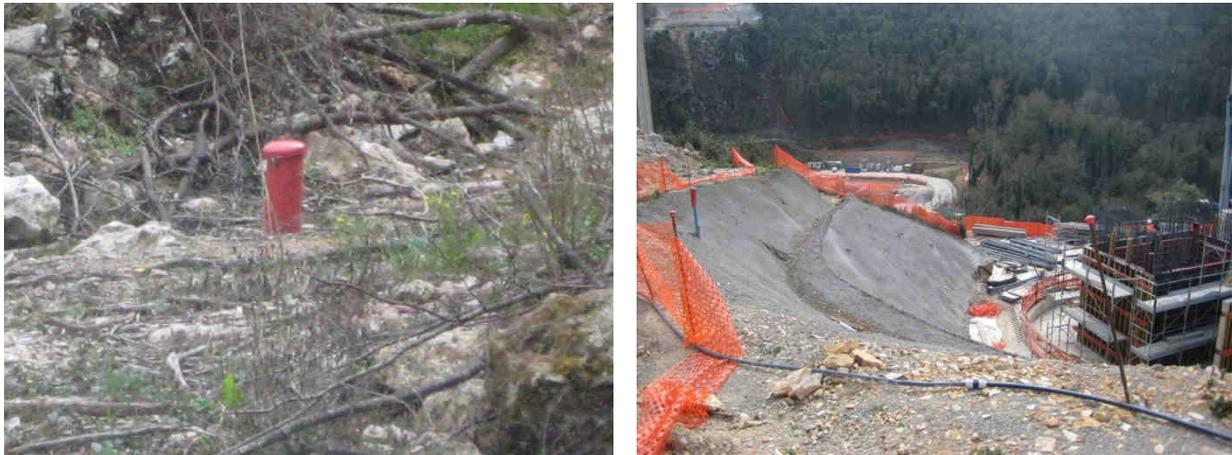
Figura 29 – Piezometro PN1 a sinistra / Piezometro PN2 a destra
