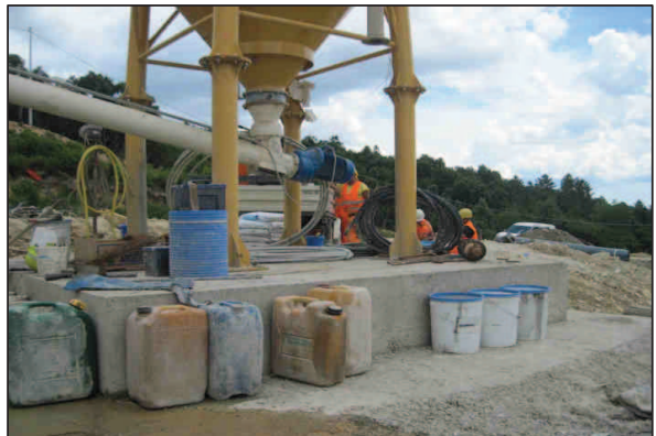
Impianto di iniezione: quadro elettrico con base in calcestruzzo (a sinistra); silos con base in calcestruzzo (a destra)
