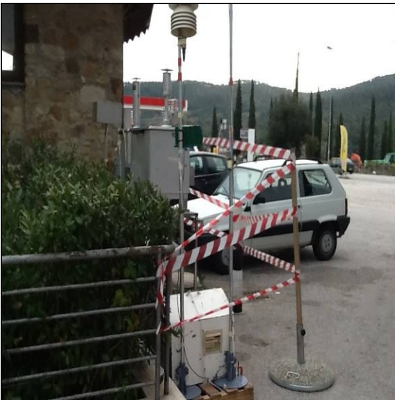
Foto 3-4 – Strumentazione di misura PTS-PM10-PM2.5 e centralina meteorologica e particolare campionatori passivi
