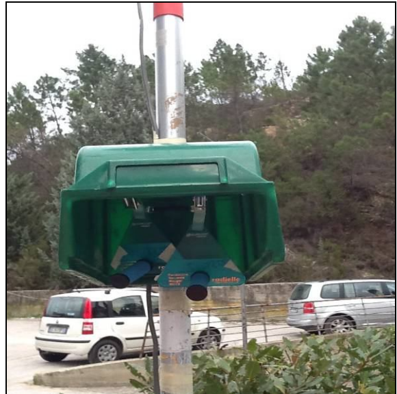
Foto 3-4 – Strumentazione di misura PTS-PM10-PM2.5 e centralina meteorologica e particolare campionatori passivi
